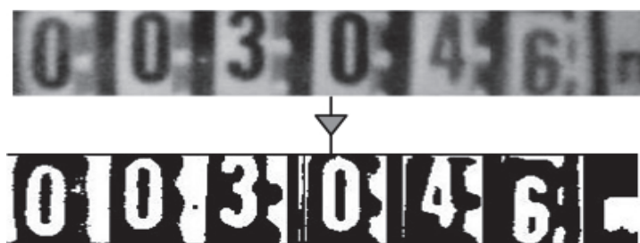
Figura 4. Região de interesse da imagem de um medidor e sua respectiva imagem segmentada.
