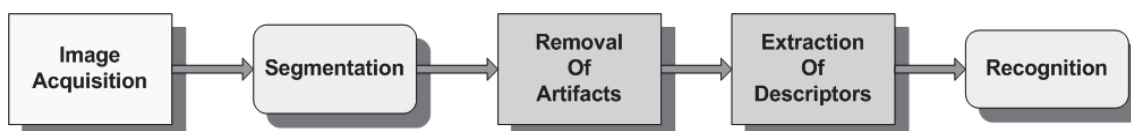
Figura 2. Diagrama de Blocos do Sistema de Aquisição e Processamento da Imagem.
