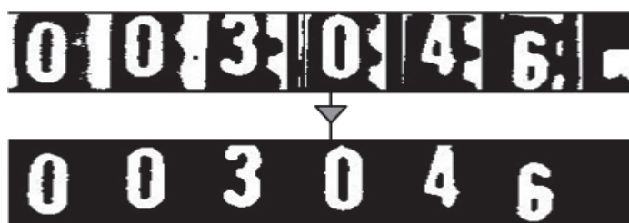
Figura 5. Imagem limpa de artefatos da imagem segmentada de um medidor
