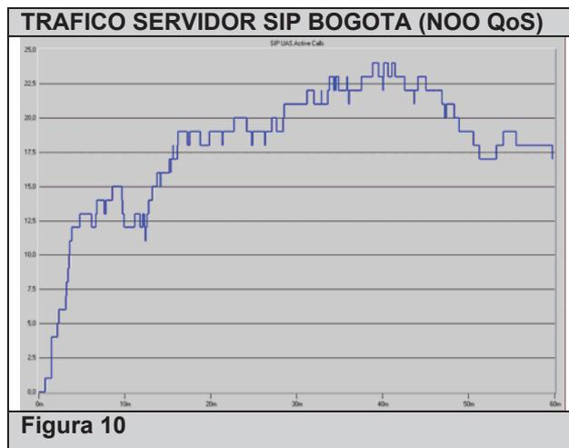
En la figura 10 se observa las llamadas activas que se efectuaron en la simulación, esta información fue obtenida del servidor Proxy Bogotá, al cual todos los nodos clientes de VoIP hacen petición del servicio de VoIP.
